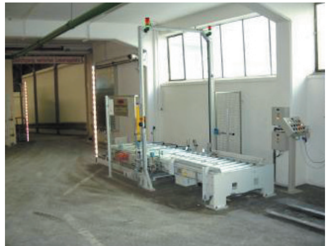
Abb. 4: Konturenkontrolle an Aufgabeposition +3,1m
