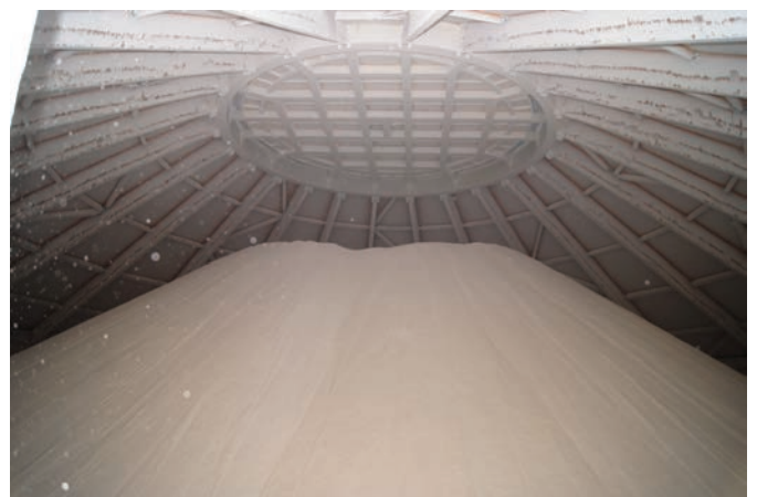
Abb. 3: Zuckerkegel im Silo – Füllung mit 57 000 t
